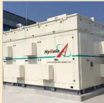
▶ 水素製造装置
