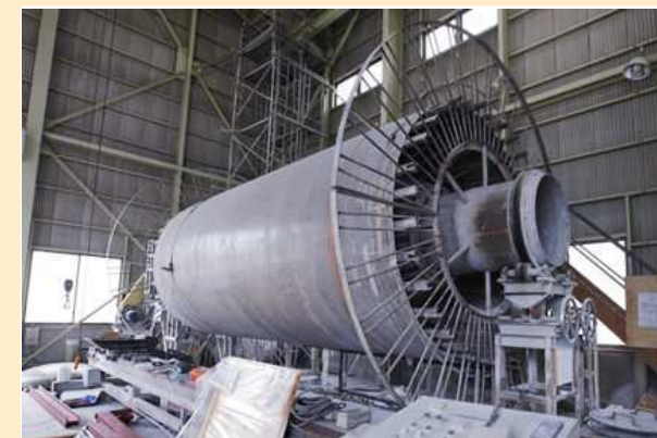
フィラメントワインディング法によるFRP生産設備(マンドレル)
