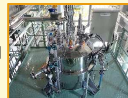
【有機性廃棄物リサイクル】 2012 汚泥熱可溶化装置
