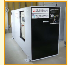
【水素製造】 2019 水電解水素製造装置 グリーン水素の製造
